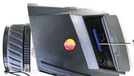
ภาพที่ ๗ แสดงภาพการนำ SD Card ออกจากกล้อง
